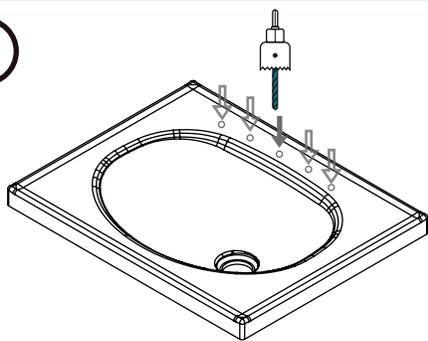
Perfore los orificios insinuados para instalar la grifería usando la copa sierra de 1 1/4". Esto se debe hacer con el lavamanos hacia arriba. Este proceso se repite para las perforaciones que la grifería requiera.
