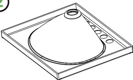
Haga una pequeña perforación solo con la broca guía, buscando el punto céntrico del orificio en el que desee instalar la grifería.
