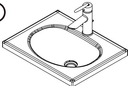
Después de perforar el orificio, pule con lija 60 y proceda a instalar la grifería de acuerdo al manual de la grifería.
