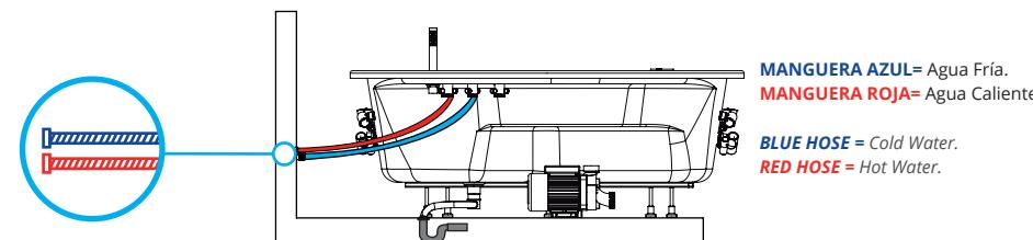
**Aplica cuando es llenado por hidrojet** / Applies when filled by hydrojet:
