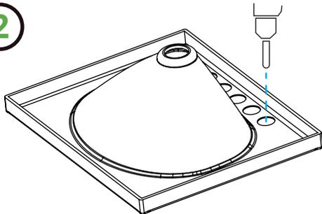
Haga una pequeña perforación solo con la broca guía, buscando el punto céntrico del orificio en el que desee instalar la grifería.
