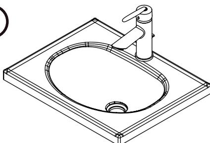
Después de perforar el orificio, pule con lija 60 el borde de la perforación y proceda a instalar la grifería de acuerdo al manual de la grifería.
