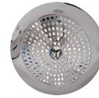
**Boquilla de succión:** Su función es succionar el agua y hacerla circular hacia la motobomba. Esta boquilla tiene una válvula liberadora de vacío, la cual detiene el sistema en el caso de un atrapamiento o taponamiento accidental de la succión.
