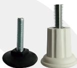
**Patas:** las patas de las bañeras se dividen en dos tipos, patas fijas y patas niveladoras; estas segundas (niveladoras) van instaladas en las varillas roscadas de la base autoportante, permitiendo entonces regular la altura y corregir desniveles o ligeras imperfecciones del piso a la hora de nivelar la bañera.
